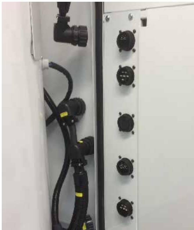
Bilden visar avmonterade bajonettkopplingar
